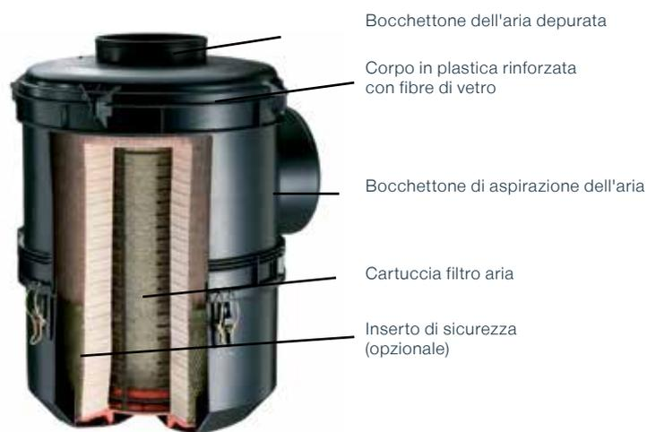
Fig. 1: Struttura di un filtro aria
